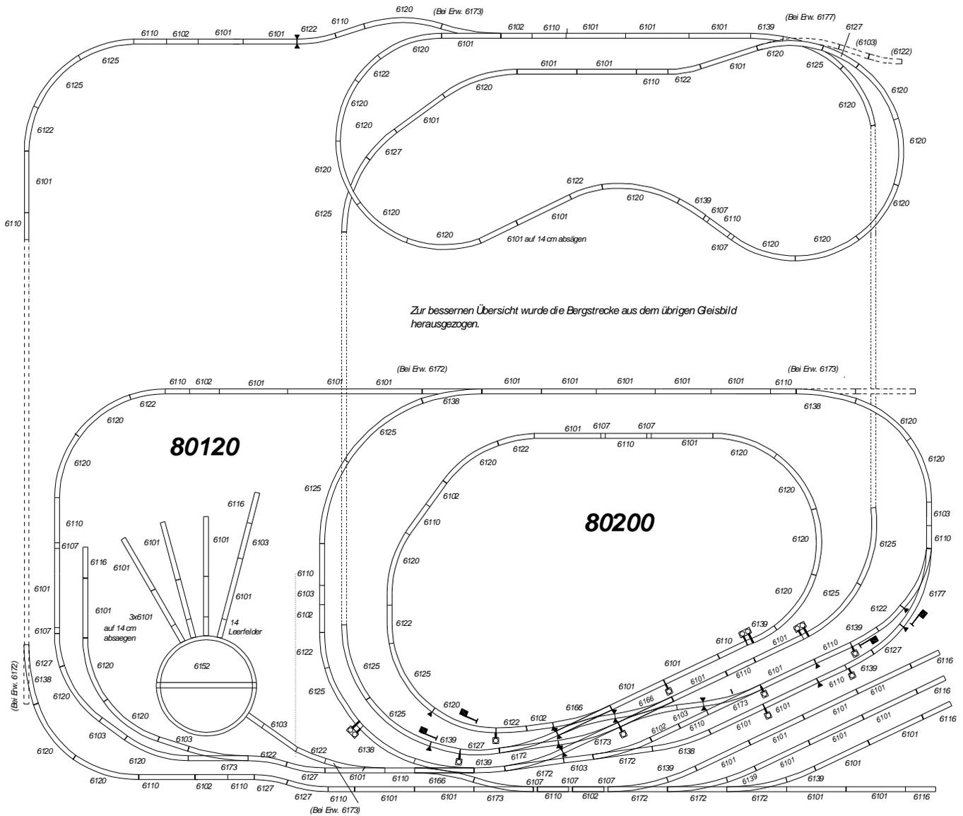
Die Weichen des Überholgleises/Abstellgleis können durch entfernen der äußeren Drahtbrücken in zweiseitig wirkende Stoppsweichen verwandelt werden dadurch können Loks nach Umstellen der Weichen Stromlos abgestellt werden. Statt 6101 abzusägen kann auch das Schienenstück 6110 verwendet werden. Für das Schienenstück 6110 kann auch das Schienenstück 6106 verwendet werden, (Gleise ausrichten und entsprechende Länge absägen. Für 6106 Schienenverbinder 6434 verwenden.
