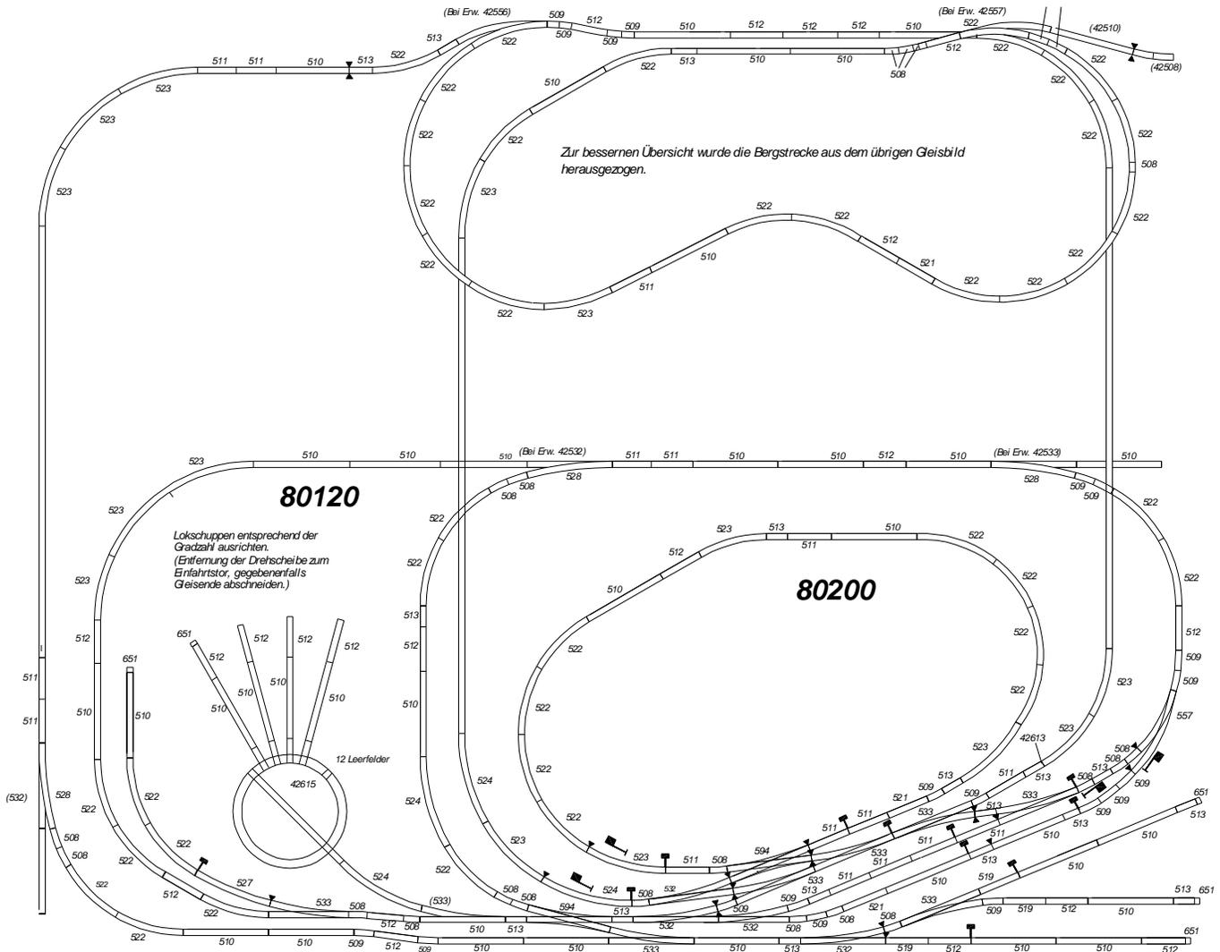
Bei den Weichen sind nach Roco Anleitung die Gleisbettungen zuzuschneiden. Die Gleisbettungen müssen dem Gelände sowie den Tunnelleinfahrten angepasst werden.
